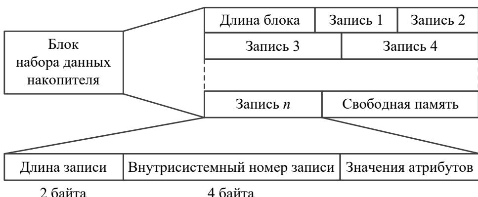
**Рис. 45.** Размещение записей в блоке
