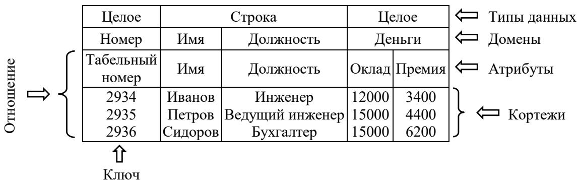
**Рис. 21.** Основные компоненты реляционного отношения
