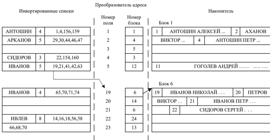
Рис. 48. Пример преобразования ВСН в адрес
