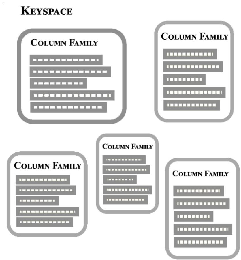
**Рис. 25.** Пространство ключей, содержащее семейства столбцов
