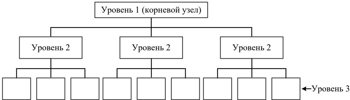
**Рис. 13.** Древовидная структура компонентов баз данных, основанных на иерархической модели хранения данных
