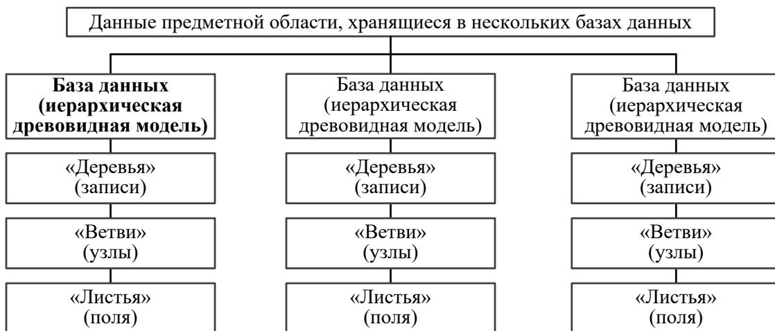
**Рис. 12.** Компоненты баз данных, основанных на иерархической модели
